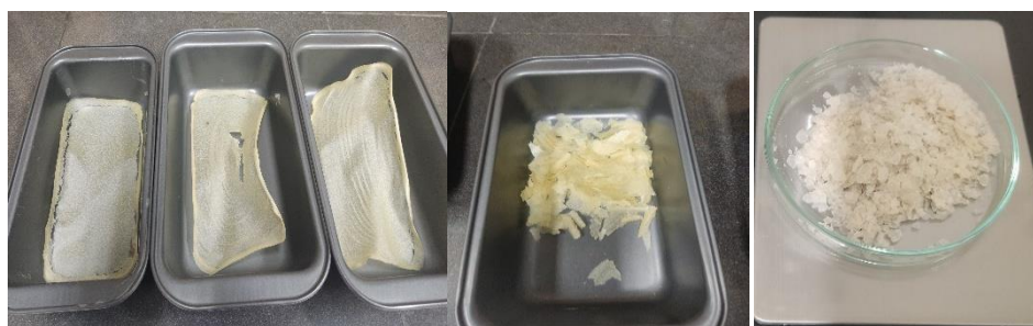
شکل ۲- نانوالیاف سلولز آسیاب شده.
