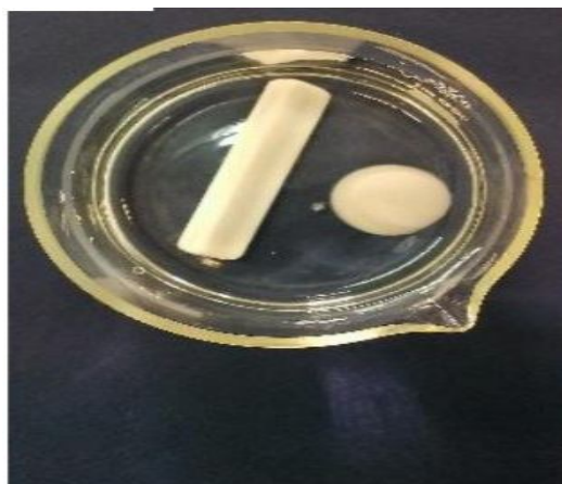
شکل ۳- ثبات ابعادی هواژل نانوسلولزی حاوی پیونددهنده عرضی.
