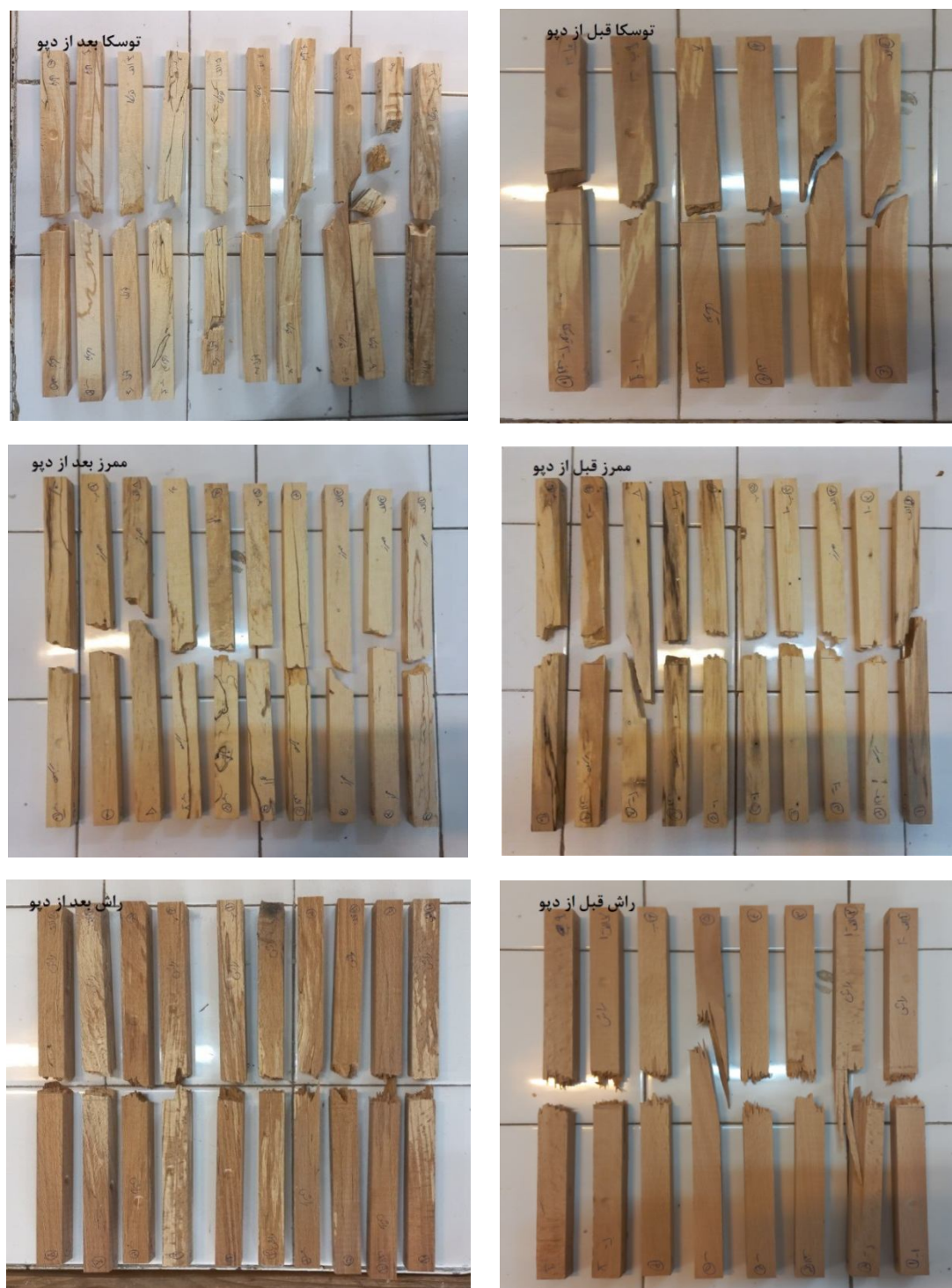
شکل ۴- تصاویر سطح شکست نمونه‌های آزمون مقاومت به ضربه چوب گونه‌های مختلف قبل و بعد از دیو چوب. Figure 4. Images of the fracture surface of impact strength for different types of wood before and after wood depot.
