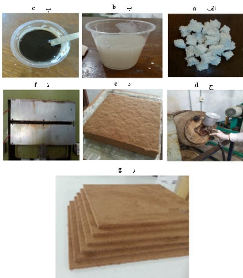
شکل ۱- فرآیند آماده‌سازی چسب و ساخت تخته فیبرهای سبک‌وزن؛ الف) قطعات خرد شده پلی استایرن، ب) فوم پلی استایرن حل شده در حلال، پ) ایزوسیانات ترکیب شده با محلول فوم، ج) اسپری چسب بروی الیاف، د) کیک الیاف، ذ) پرس گرم، ر) تخته فیبرهای سبک‌وزن.
