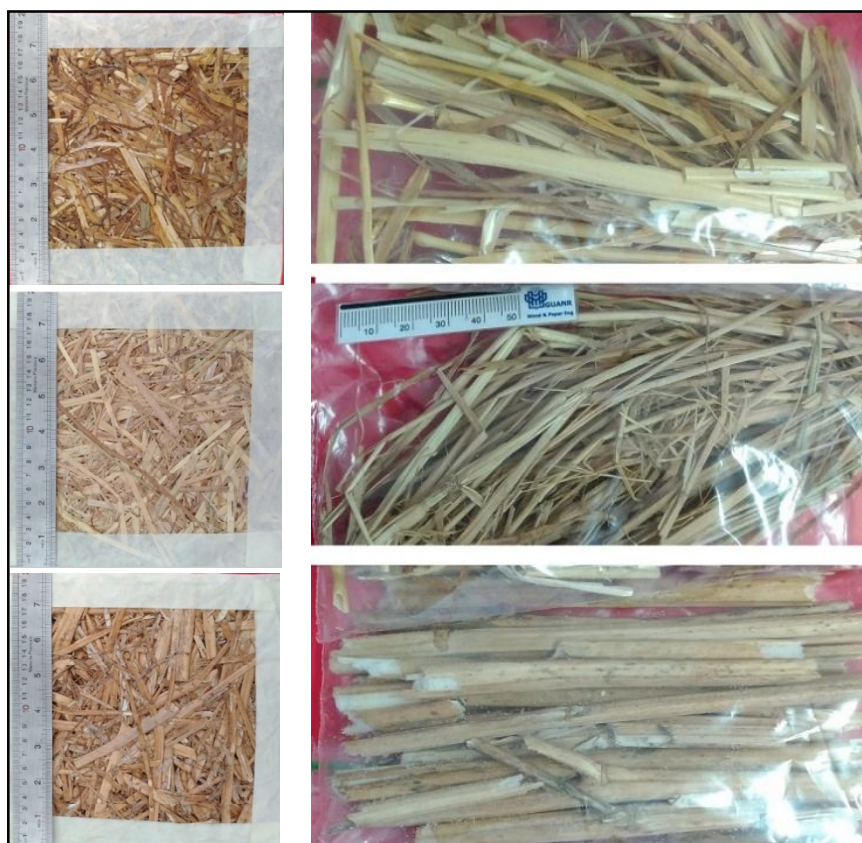
شکل ۱- مواد اولیه و پانل‌های عایقی ساخته شده (بالا: کاه گندم، وسط: کاه برنج و پایین: کاه کلزا).
