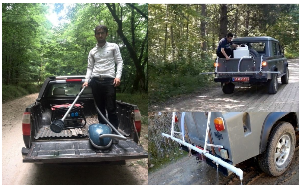
شکل ۲- (الف) سامانه پاشش محلول‌های ضد غبار و (ب) دستگاه مکنده غبار.
