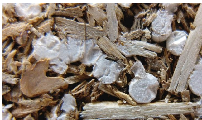
شکل ۱- نمایی از پلیمر و خرده چوب در تخته ساخته شده.
