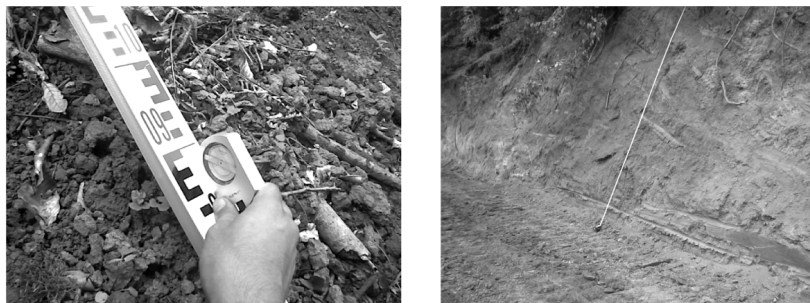
شکل ۲- برداشت مشخصات مقطع عرضی ساخته شده با متر فلزی، شیب‌سنج و شاخص.
