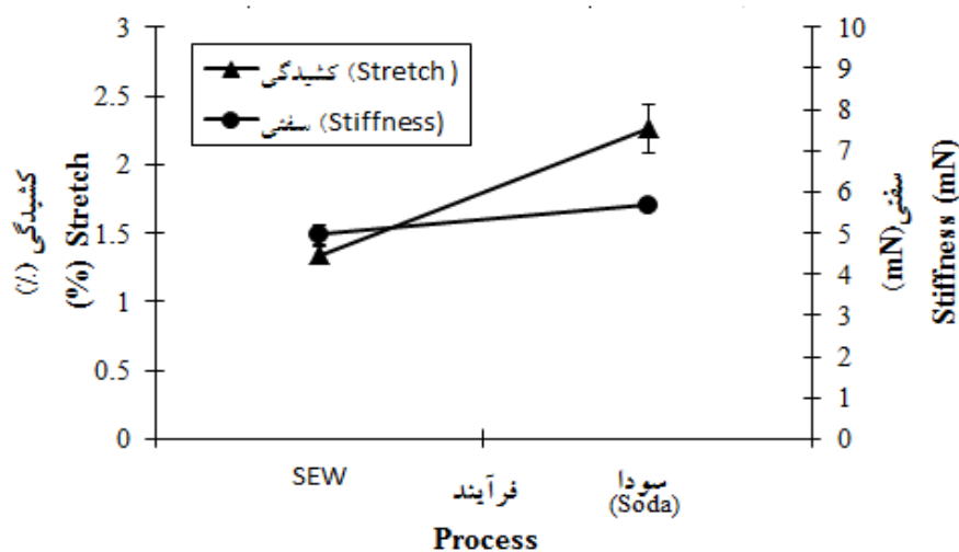
شکل ۹- مقایسه ویژگی‌های سفتی و کشیدگی کاغذهای SEW و سودا. Figure 9. Comparison between the stiffness and stretch of SEW and soda papers.
