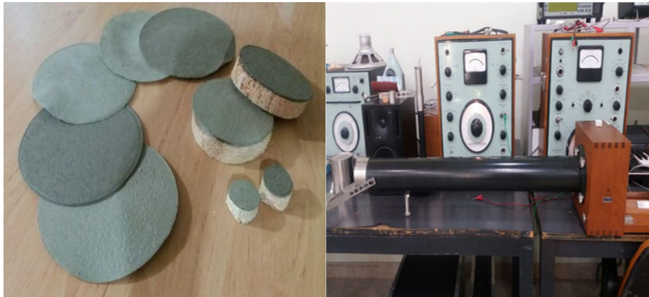
شکل ۱- دستگاه لوله امواج ساکن (سمت راست) و دیسک‌های آزمون (سمت چپ).
