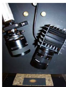
شکل ۲- تجهیزات اندازه‌گیری تغییرات درخشش چاپ. دست چپ دستگاه تابنده نور ۱ و دست راست دوربین قرار دارد. این دستگاه در انستیتو تحقیقاتی خمیر و کاغذ سوئد ساخته شده است و در حال حاضر در آنجا قرار دارد (مک گرگور و جانسون، ۱۹۹۰).
