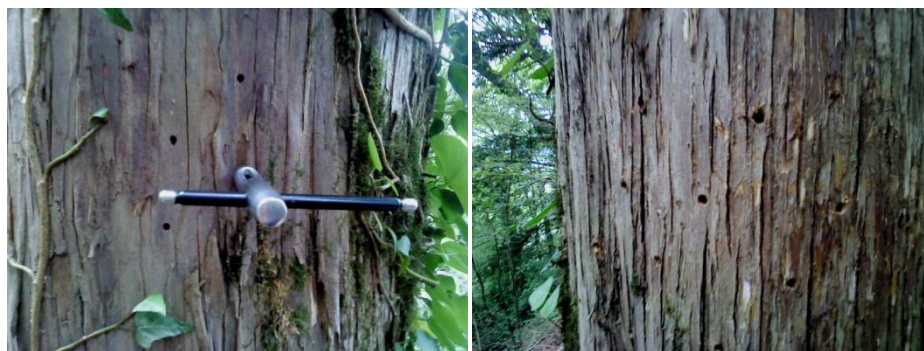
شکل ۱- الگوی نمونه‌برداری به وسیله دستگاه تروپار بر روی تنه درخت سرخدار.
