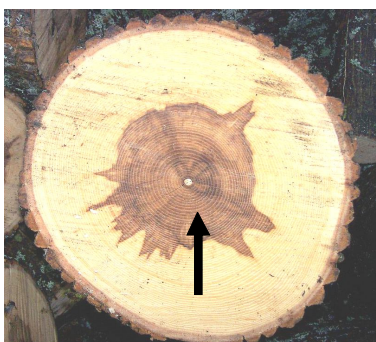
شکل ۱- دیسکی از چوب راش واجد پدیده دل قرمزی، ناحیه دل قرمزی با پیکان نشان داده شده است.
