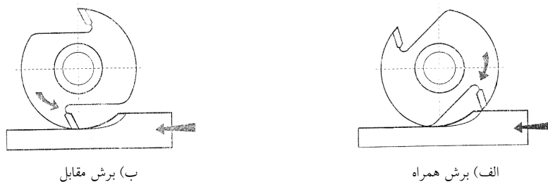
شکل ۱- حرکت محور دستگاه CNC در برش همراه و مقابل.
